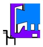
Bei Stillstand bewirken die Umlauf-, Labyrinthund Rücklaufnuten, dass keine Flüssigkeit zwischen Welle und Stator ein- oder austreten kann. Seite 5/26
