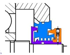
dass aus dem Lager austretendes Öl, welches an den Flächen des stehenden Maschinenteils haftet, an dem umlaufenden drehenden Maschinenteil bzw. dem mit diesem drehenden Maschinenteil umlaufenden Dichtelement entlang wandert. Es wird zunächst durch die unterschiedlichen Hindernisse dieser berührungslosen verzahnten Konusflächen der Spritzring und Umlaufnuten aufgehalten, umgeleitet und in dem Ölsumpf abgeführt. Die Labyrinthnuten des statischen Dichtelementes werden nicht beansprucht.
