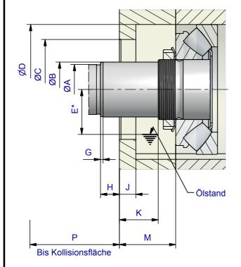
Einbaulage horizontal, mit rotierender Welle
